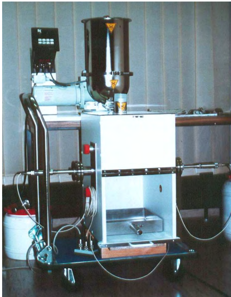
Abbildung 1.3: Messapparatur zur Klassifizierung der Staubungsneigung, wie sie zu Beginn der Diplomarbeit vorhanden war. Der Innenraum ist mit Teflon ausgekleidet.
