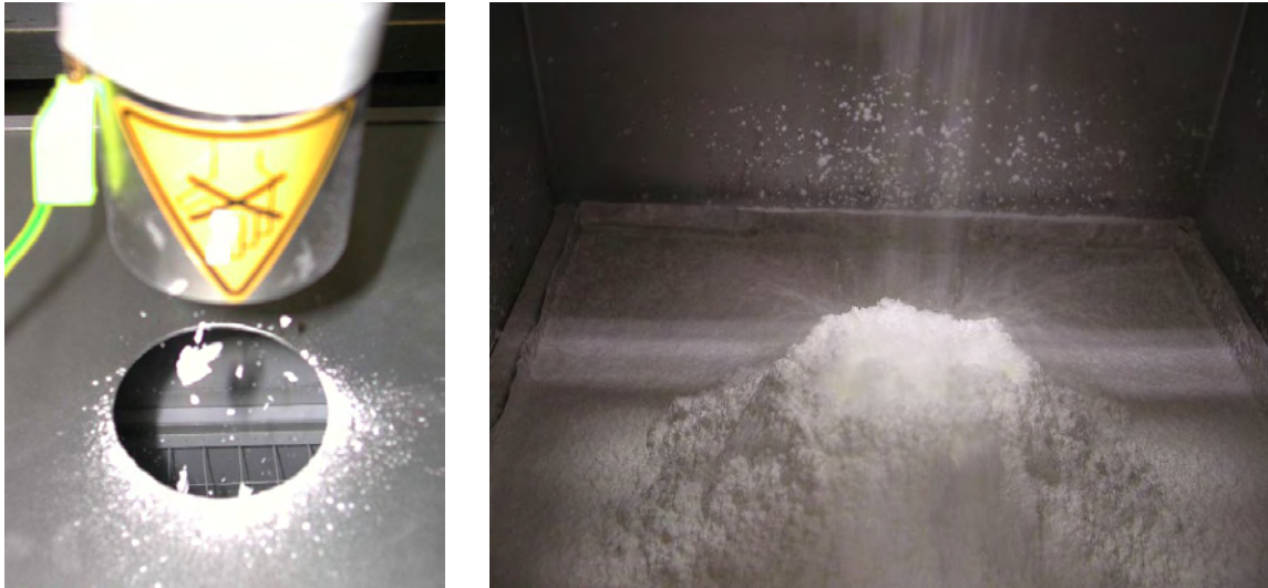
Abbildung 5.7: Am Ausstrag bilden sich Agglomerate (links), die beim Fall undefiniert zerfallen. Beim Auftreffen auf den Produktkegel in der Schaufel wird Staub aufgewirbelt (rechts).
