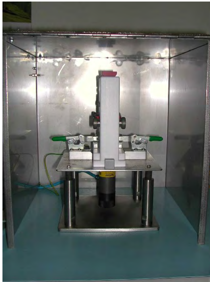
Abbildung 4.4: Apparatur mit Vibrations-Messzelle zur Messung des spezifischen Staubwiderstandes in Anlehnung an die DIN EN 61241-2-2.
