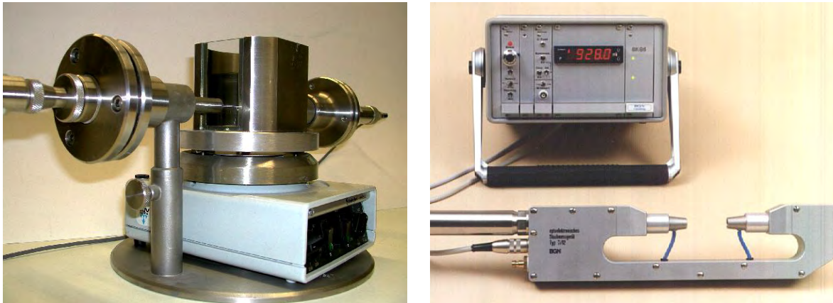
Abbildung 3.3: Vorrichtung zur Erfassung der Kalibrierkurve des SKG 5 (links) und das SKG 5 (rechts).
