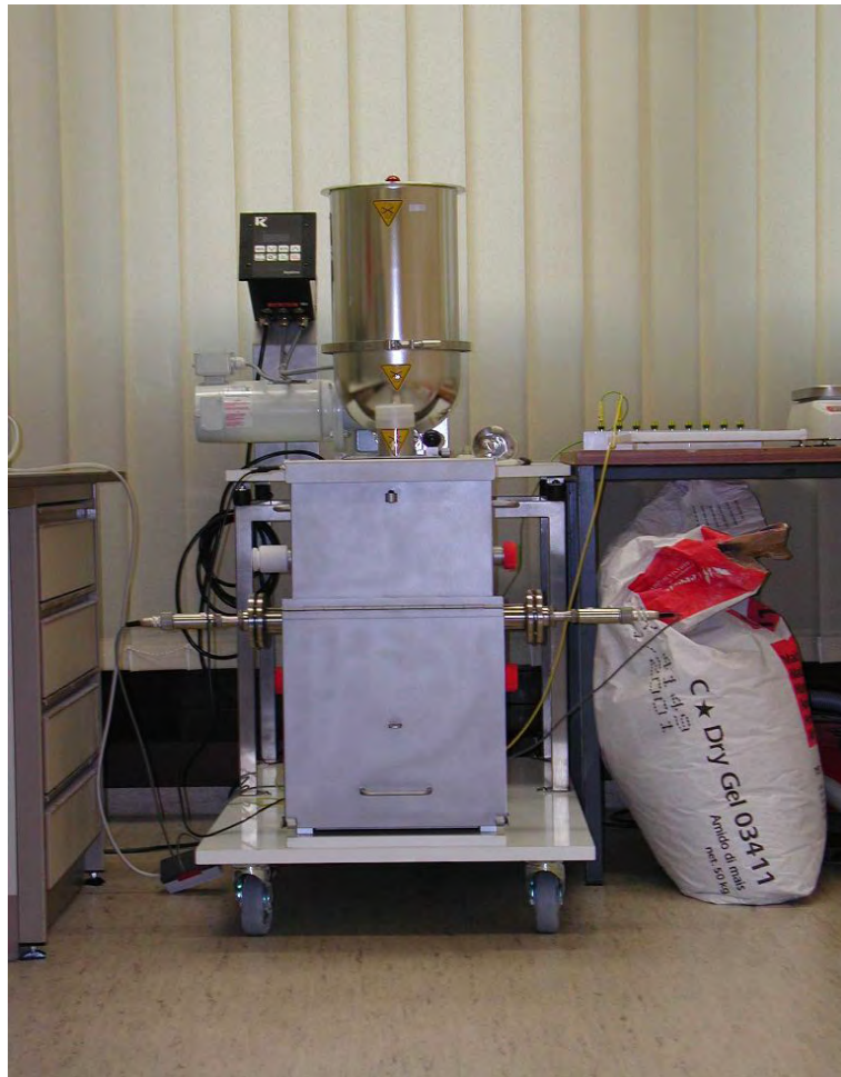
Abbildung 5.1: Staubungsneigungsapparatur mit Messkammer aus Stahl.
