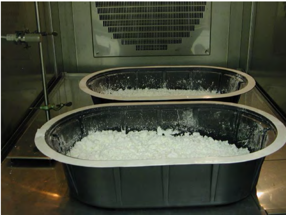
Abbildung 7.7: Zur Einstellung hoher Produktfeuchten wurde der Prüfstaub mehrere Tage bei 95 % r.F. und T = 25\text{ °C} in der Klimakammer gelagert.
