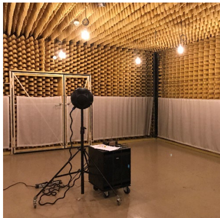
Abbildung 31: Reflexionsarmer Halbraum der BGN mit Globe Sub zur Ermittlung der Nachhallzeit mit konstantem rosa Rauschen
