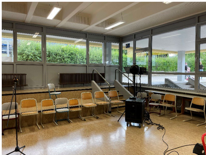
Abbildung 47: Musikraum einer Schule in Bad Rappenau mit Aufbau der Globe Source zu Ermittlung der raumakustischen Kenndaten mit dem B&K 2270
