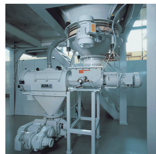
Abbildung 25: Silo mit nachgeschalteter Wirbelstromsiebmaschine In der Anlage im rechten Bild wurden die oben beschriebenen vorbeugenden Maßnahmen konsequent umgesetzt, daher sind keine zusätzlichen konstruktiven Maßnahmen notwendig. Im linken Bild ist die Wirbelstromsiebmaschine zusätzlich mit einer flammenlosen Druckentlastung geschützt. [Bild: AZO® GmbH & CO KG]
