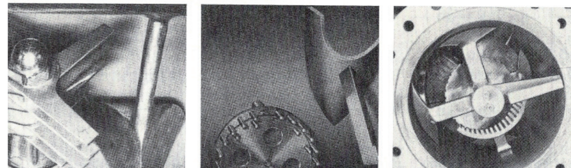
Abbildung 16: Beispiele von Misch-Werkzeugen (oben) und Desagglomerier-Werkzeugen (unten) [Bild: Prof. Dr.-Ing. Drs. h. c. Manfred H. Pahl, Universität Paderborn]
