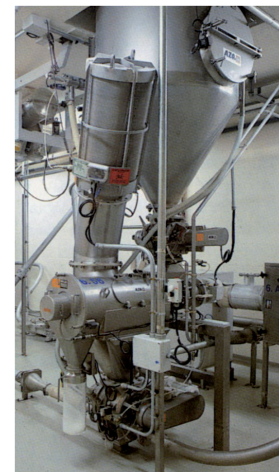
Abbildung 25: Silo mit nachgeschalteter Wirbelstromsiebmaschine In der Anlage im rechten Bild wurden die oben beschriebenen vorbeugenden Maßnahmen konsequent umgesetzt, daher sind keine zusätzlichen konstruktiven Maßnahmen notwendig. Im linken Bild ist die Wirbelstromsiebmaschine zusätzlich mit einer flammenlosen Druckentlastung geschützt. [Bild: AZO® GmbH & CO KG]
